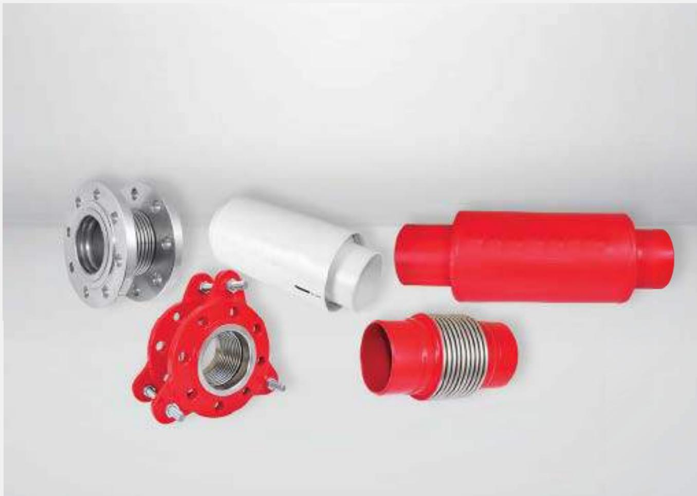
Под воздействием температуры на трубопровод, сильфон упруго деформируется, позволяя трубопроводу оставаться в первоначальном положении: при увеличении температуры сильфон сжимается, при понижении-растягивается. Таким образом, применение сильфонных компенсаторов позволяет устраниить негативные последствия температурного удлинения трубопровода и свести к минимуму деформацию трубопровода.
